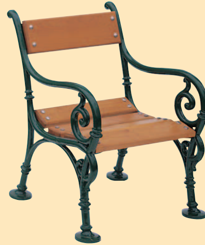
Sessel: Art. 6136 Seitenteile Aluminiumguss, pulverbeschichtet, Farbe nach RAL, Schrauben Edelstahl, Belattung: 500 mm Hartholz, H 820 x B 560 x T 680 mm, Sitzhöhe: 360 mm
